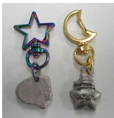
鋳造とは、作りたい物の形と同じ形の空洞をもつ「型」に、溶けた金属を流し込んで、それを冷やして固める製造法です。自動車や船、農作業をする機械にも、鋳造の製品は多く使われています。今回は「140度」で溶かして、金属のかたまりが、自分の作りたい形になるのを体感してみましよう。
